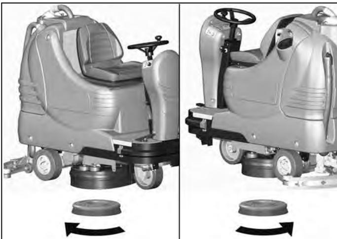
On conseille d'inverser chaque jour la position des brosses afin d'en assurer un emploi plus durable. Si les brosses sont déformées inévitablement nous vous conseillons de les remonter dans la même position, pour éviter qu'une inclinaison différente des brins provoque des efforts excessifs au moteur ou soit cause des vibrations désagréables.
