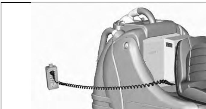
**Ne jamais charger une batterie de type GEL avec un chargeur de batteries non adapté. Suivre scrupuleusement les instructions fournies du fabricant des batteries et du chargeur des batteries.**
