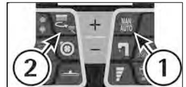
Sur le display deviendra clignotant la valeur de P1, P2 ou P3. Appuyer sur les boutons (+) et (-) pour sélectionner la pression, à la fin des éclairs la valeur est réglée.
